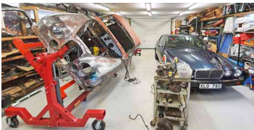
Karossen monterad i vagnen. Med en ställskruv kan tyngdpunkten i vagnen justeras så att karossen med handkraft lätt kan roteras. Höjden justeras med hydraulik, som en domkraft, för rätt arbetsställning. Den vakuumdrevna bromsservon har just demonterats och ligger på golvet i förgrunden i väntan på renovering
