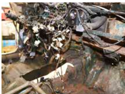
Bakom vackra träpaneler och instrument döljer sig kabelhärvor som kräver noggrann dokumentation
